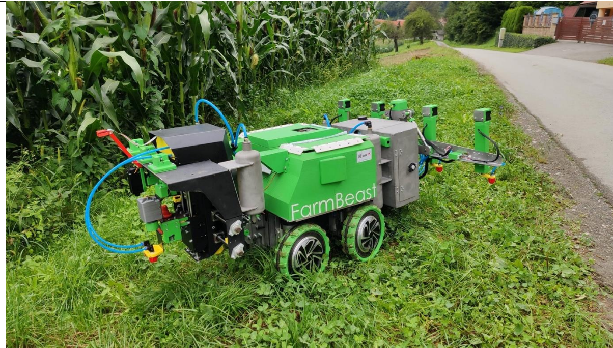
Slika 1: Robot FarmBeast z nameščenim orodjem za selektiven nanos FFS spredaj in zadaj. Sprednji del omogoča nastavljanje šobe v širini robota, zadnji pa je namenjen horizontalnemu in vertikalnemu nanosu.
