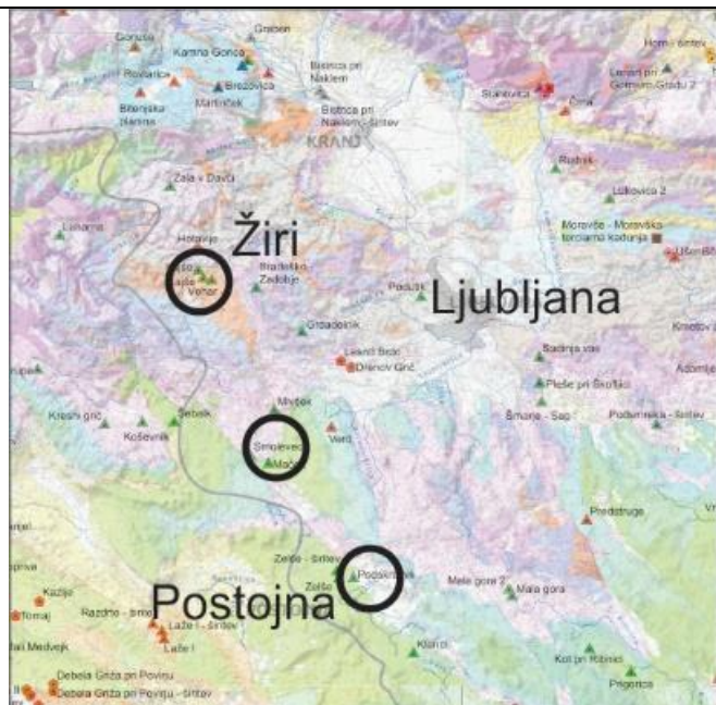
Slika 2: Najverjetnejši viri agregata za gradnjo Rupnikove linije, kjer so označena možna območja pridobivanja dolomitnega agregata. Iz slike je razvidno, da na tem območju prevladujejo karbonatne kamnine triasne (vijolična), jurske (modra) in kredne (zelena) starosti.
