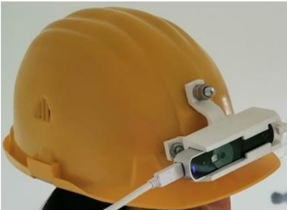
Slika 1: 3D skener Structure Core integriran v nosilcu (nosilec izdelanim v okviru PKP projekta APP4ACCPM) in pritrjenim na zaščitno čelado delavca, ki omogoča avtomatsko zajemanje podatkov v obliki oblaka točk.
